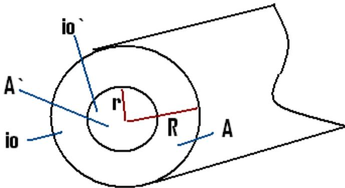
A : area de la sección transversal del conductor de radio R y que es recorrida por la corriente  $i_o$
